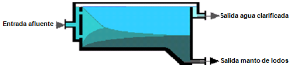
Figura 32. Configuración típica de sedimentación flujo horizontal
