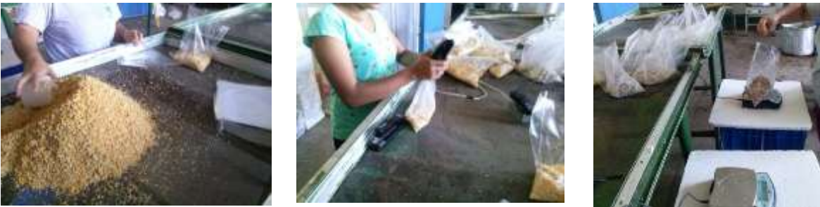
Figura 22. Fase de remoción de exceso de humedad, pesado y embolsado de los sustratos
