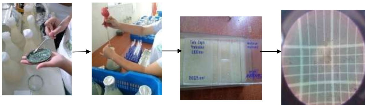
Figura 19. Flujograma de la obtención y conteo de concentración de matrices madre para inoculación.
