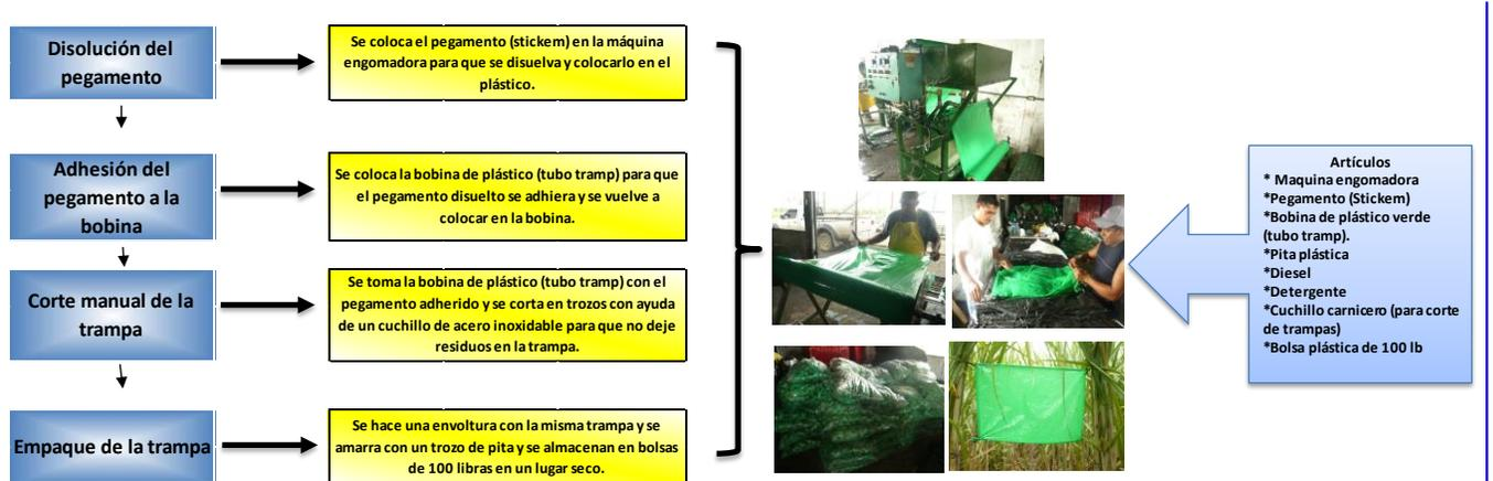
Figura 7 Metodología de producción de trampas verdes adhesivas para el control de chinche salivosa.
