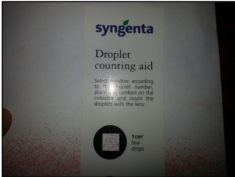
Figura 26. Conteo y distribución de gotas por centímetro cuadrado (experimental).
