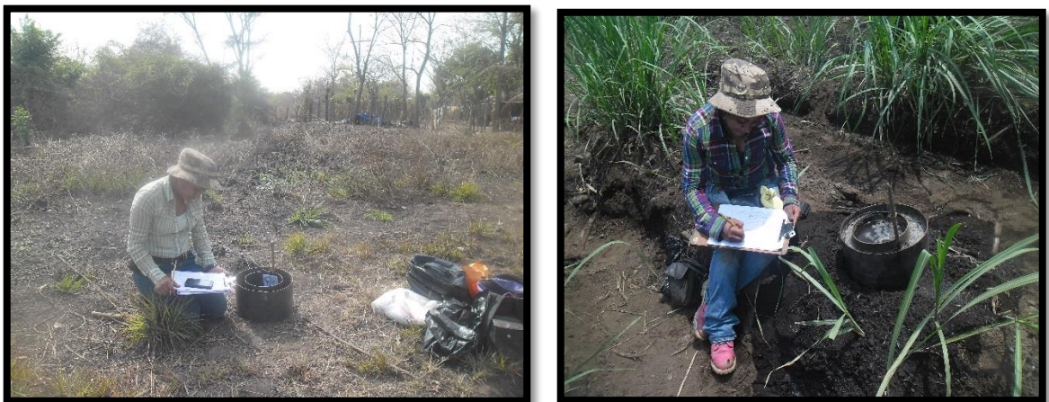
Figura 60A: Realización de la calicata, descripción del perfil, toma de datos, toma y llenado de muestras de suelo.
