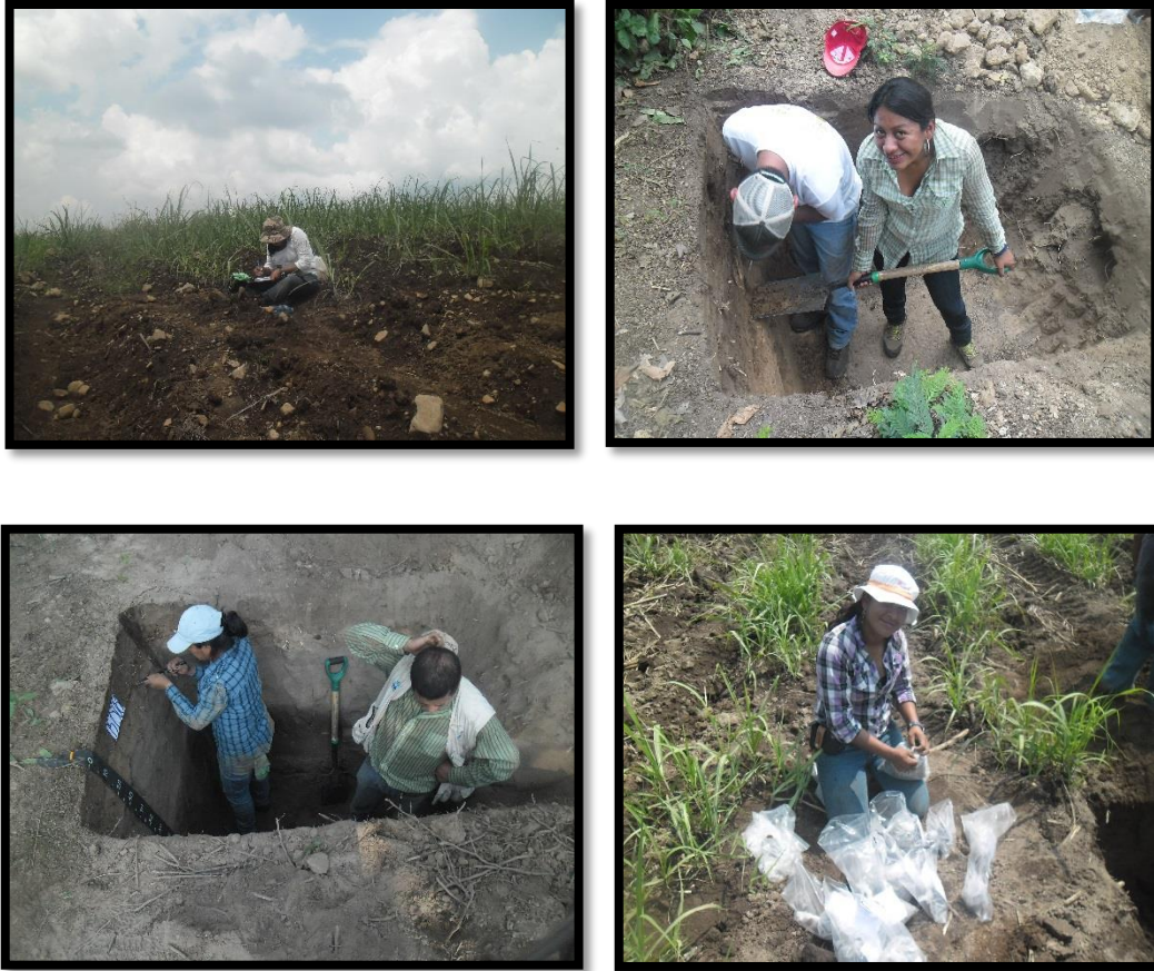
Figura 60A: Realización de la calicata, descripción del perfil, toma de datos, toma y llenado de muestras de suelo.
