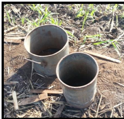
Figura 21. Cilindros colocados en el lugar determinado para realizar la prueba de infiltración.
