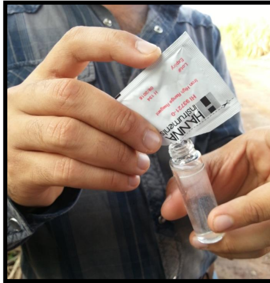
Figura 12. Aplicación de reactivo específico de Hierro en recipiente C2.
