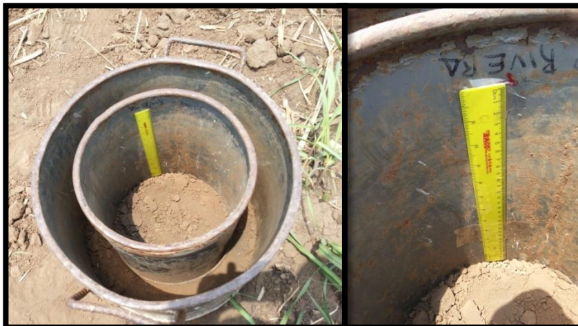
Figura 23. Marca en el cilindro y colocación de regla a 30 cm del suelo para toma de alturas a través del tiempo.
