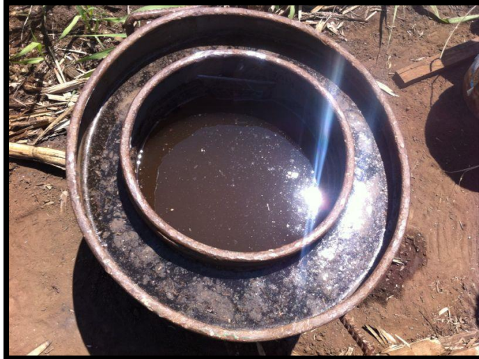
Figura 24. Cilindros llenos con agua hasta una altura de 30 cm desde el suelo.
