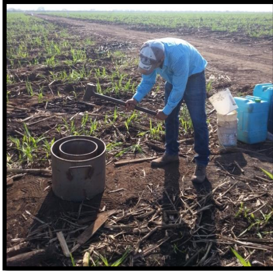
Figura 22. Golpeo para introducir los cilindros en el suelo.
