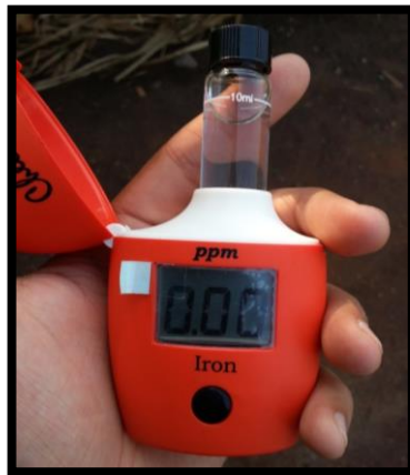
Figura 15. Cuantificador mostrando la concentración de Hierro contenida en una muestra de agua.
