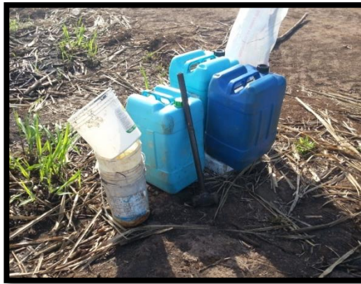
Figura 20. Material a utilizar en el punto elegido para realizar prueba de infiltración.
