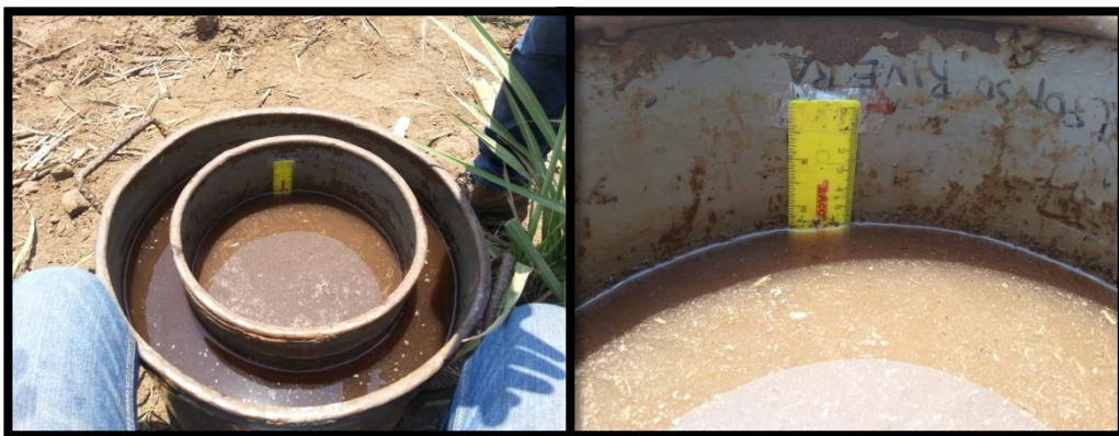
Figura 25. Toma de lecturas de altura en el cilindro interior.
