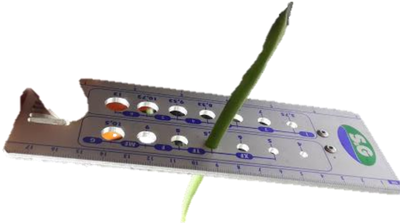
Figura 7. Placa para establecer el diámetro del ejote.
