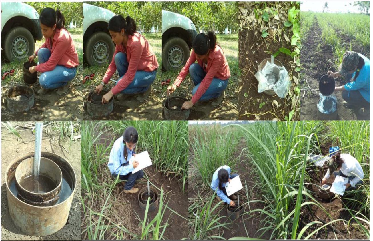
Figura 50. Montaje del equipo y realización de pruebas de infiltración
