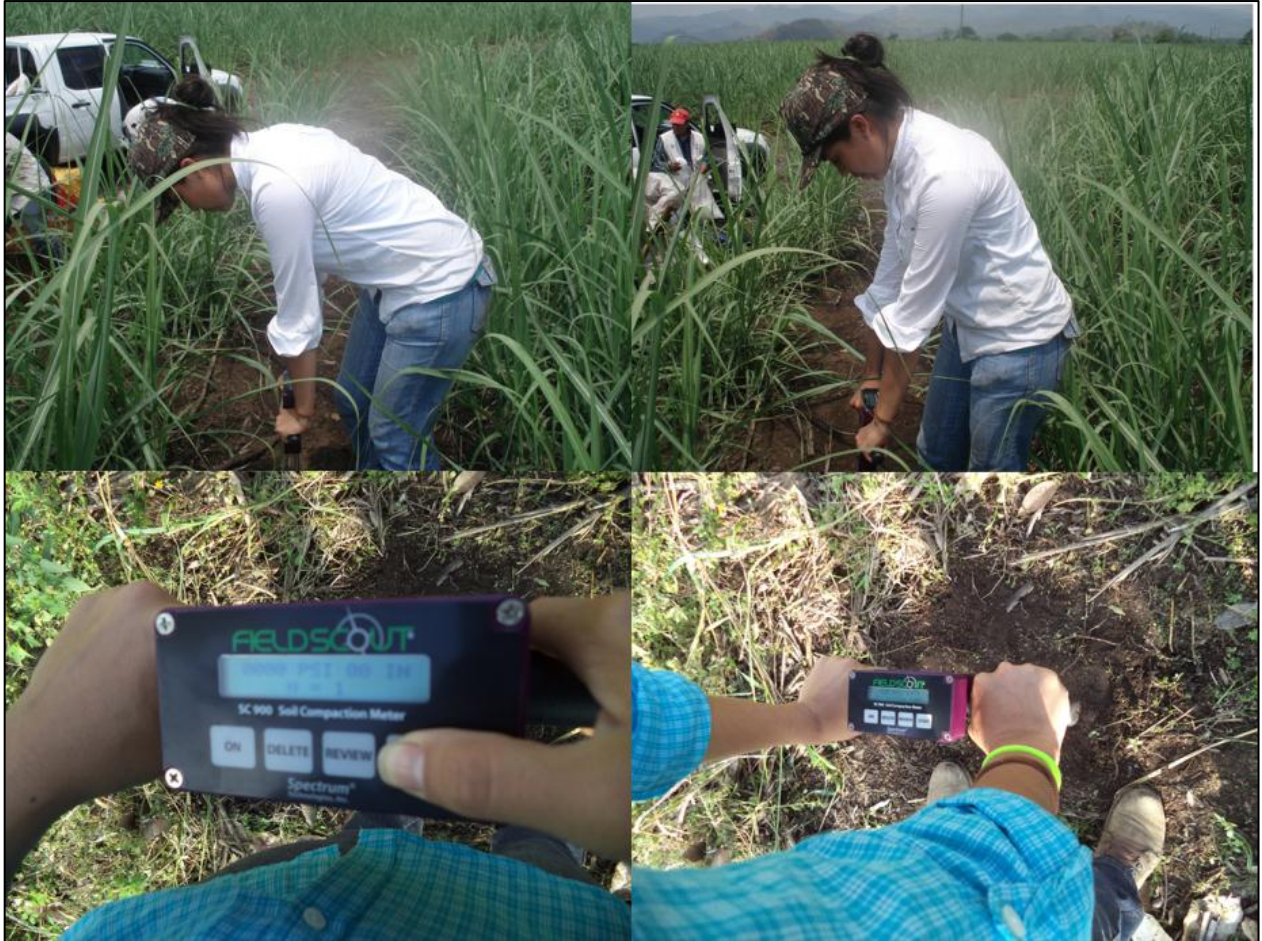
Figura 55. Prueba de compactación del suelo
