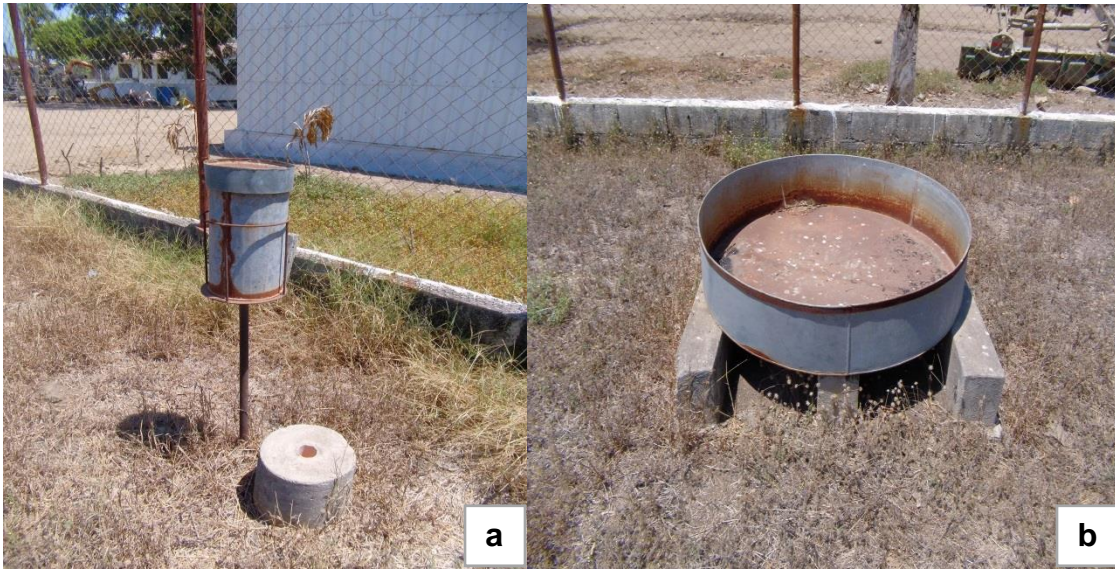
Figura 45 Pluviómetros convencionales (a) y tanque de evaporación (b).
