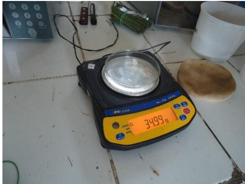
Figura 2.26 Pesaje del recipiente vacío a utilizar para el secado de las muestras
