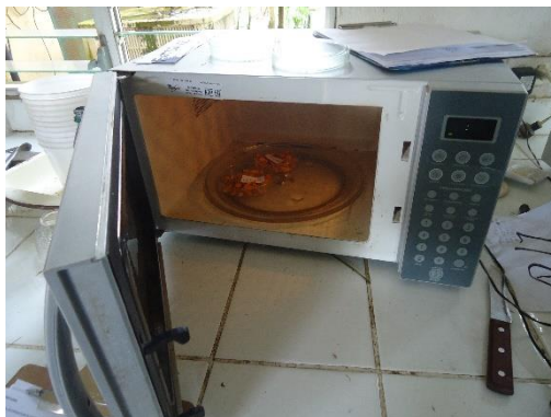
Figura 2.28 Deshidratado de la muestra en hornos microondas
