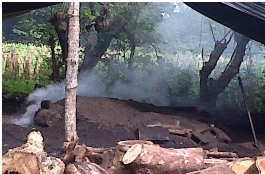
*Figura 19. Chimeneas del horno*
