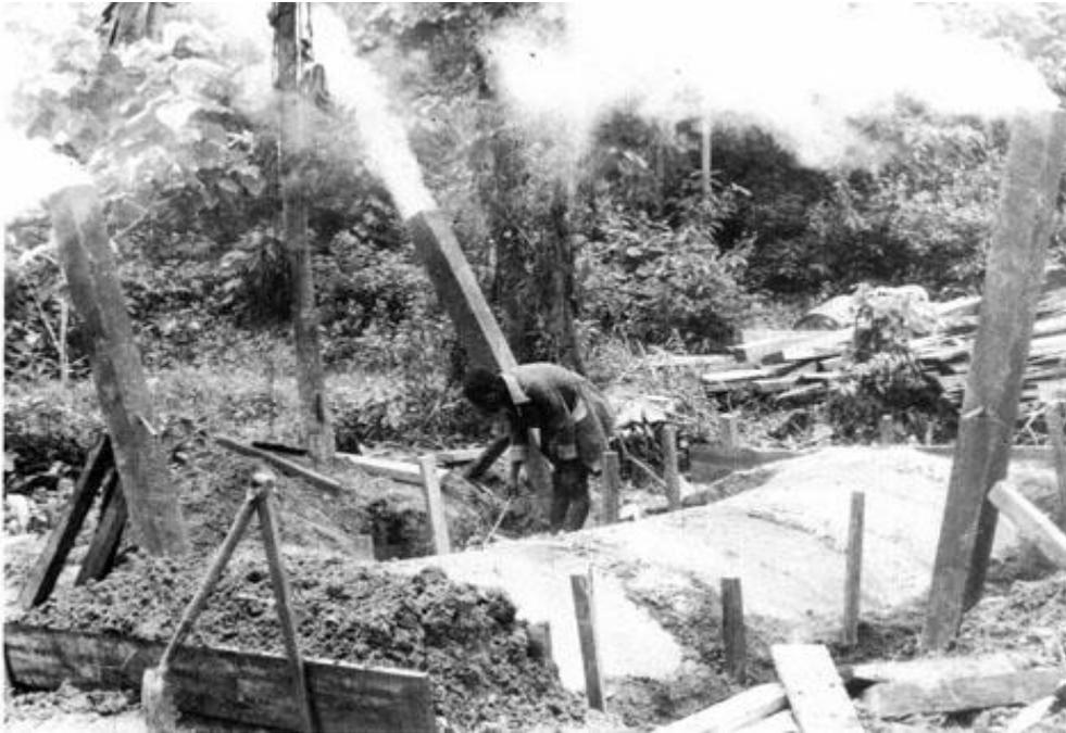
*Figura 4. Fosa de tierra durante la quema. Obsérvense las chimeneas de acero y la cubierta hecha con láminas, selladas con tierra. Ghana. Foto Lejeune (5) FAO, Capítulo 5, Fabricación de Carbón Vegetal en grandes Fosas*
