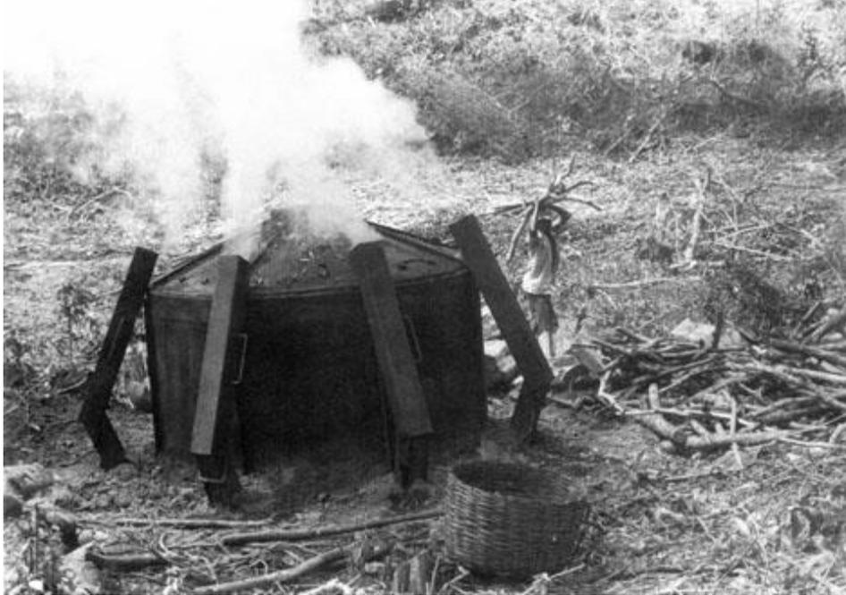
*.Figura 6. Carbonera de acero y fosa de tierra. Observar las chimeneas para el humo que están enterradas en el suelo y el tipo de leña empleado. Ghana.
