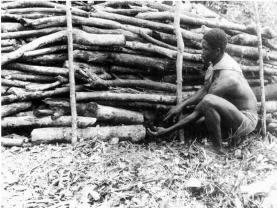
*Figura 7. Carbonera de parva de tierra en construcción indicando el punto de encendido. Ghana.
