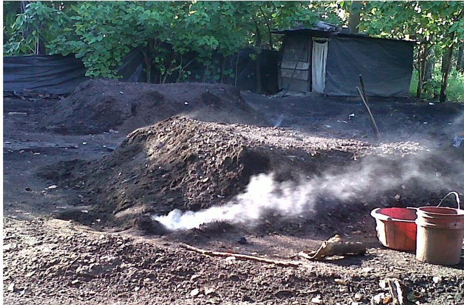
*Figura 18. Cubierta del horno*
