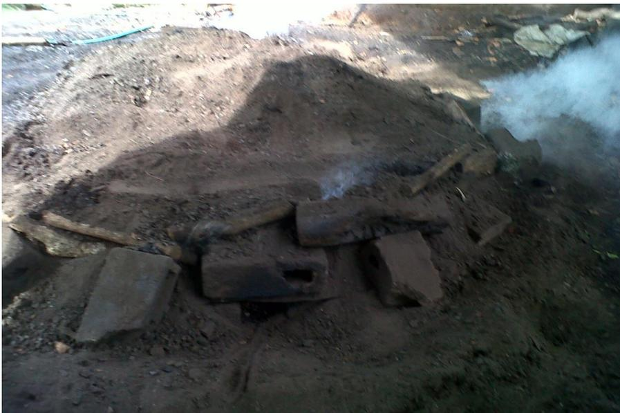
*Figura 21. Enfriado del horno*
