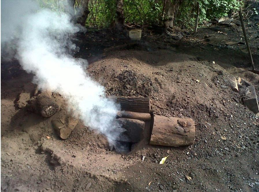
*Figura 20. Diferentes colores de humo según el proceso de carbonización*
