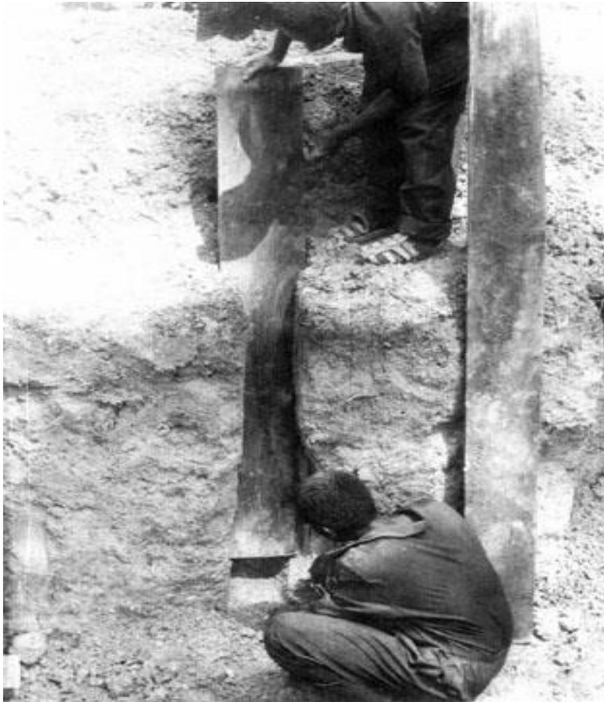
*Figura 5. Los respiradores de los hornos de fosa pueden ser forrados con madera cuando el suelo es suelto, evitando la necesidad del acero. Ghana.*
