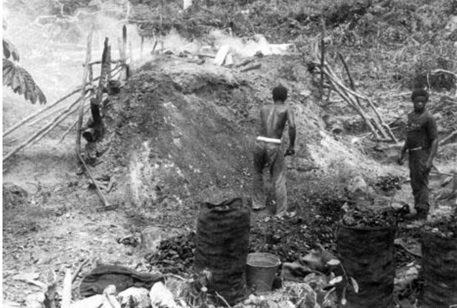
*Figura 10. Descarga en bolsas del carbón vegetal de una carbonera de tierra. Observe el rastrillo usado para separar el carbón mezclado en la capa de tierra durante las primeras etapas de la descarga. Ghana.*
