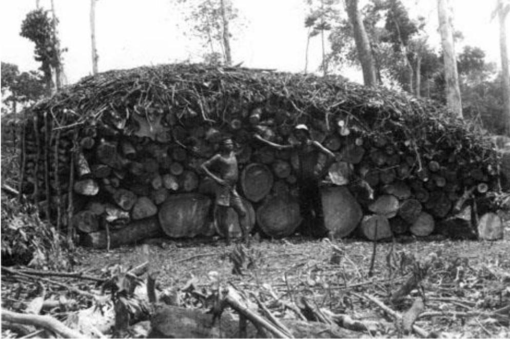
*Figura 8. Parva de tierra durante su construcción. Observar las trozas de gran diámetro colocadas en la base de las pilas. Ghana.
