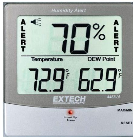
**Figura13. Fotografía de un Higrotermómetro medidor de Temperatura (°C y Humedad Relativa (%)).**
