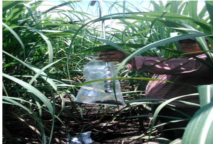
Figura 34. Barreno helicoidal para recolección de muestras de suelo para análisis de los indicadores biológicos
