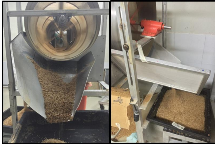
Figura 16. Máquina de separado de larva de la dieta.. B: Larva recuperada en un recipiente San Miguel Petapa, 2015.
