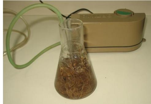
**Figura 18.** Extracción de nematodos con aireación.
