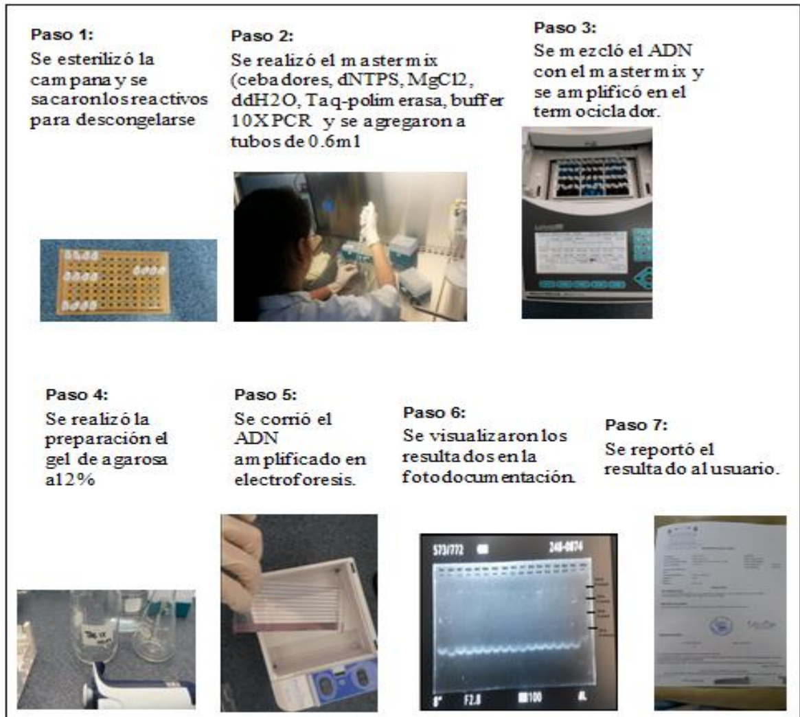
Figura 20. Serie de fotografías del protocolo para amplificación de ADN en nematodos, según Hu, M. X., Zhuo, K., and Liao, J. L. 2011.
