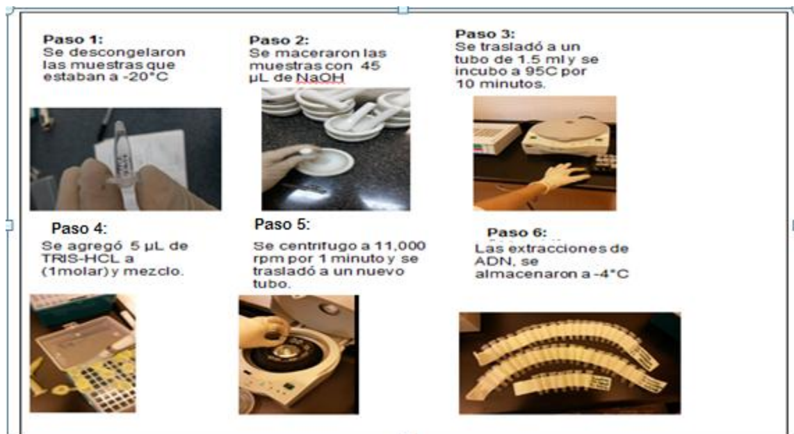
Figura 19. Serie de fotografías del protocolo para extracción de ADN según Stanton, J. M., McNicol, C. G., and Steele, V. 1998.
