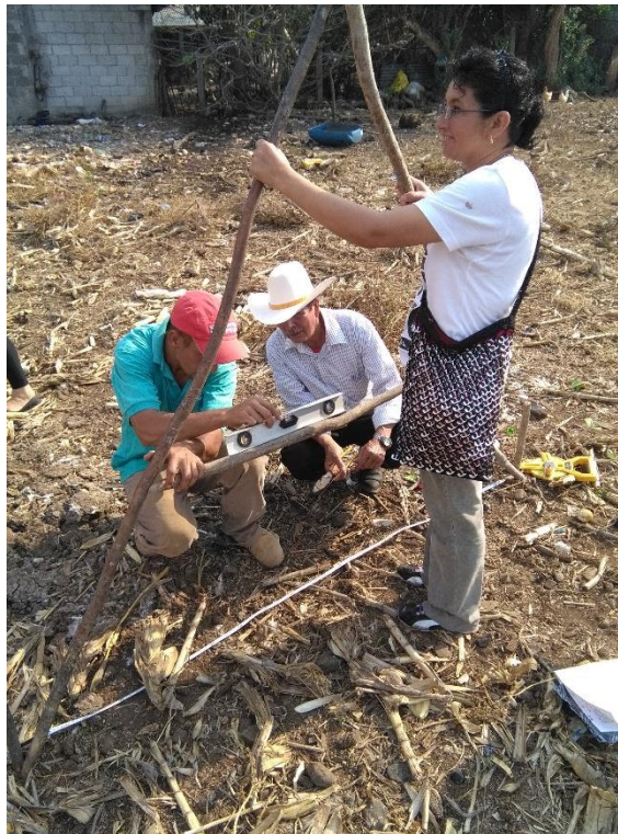
Figura 33 Productores de la comunidad de Las Animas elaborando un nivel en A
