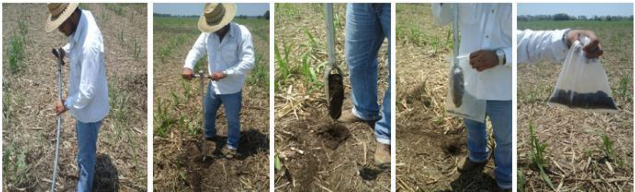
Figura 13 Metodología para la toma de muestras con barreno para clasificación de clase textural.
