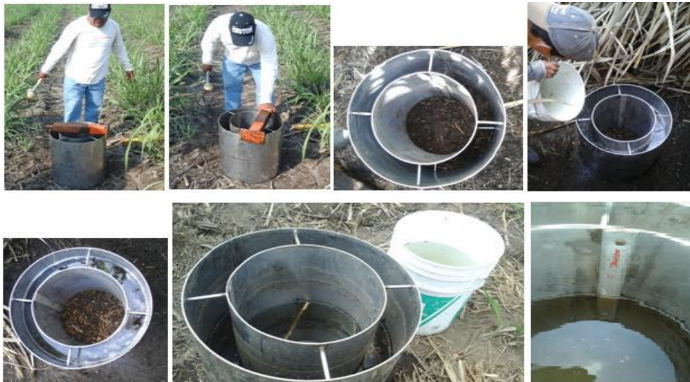
Figura 16 Metodología para la determinación de la infiltración por el método de infiltrómetro de doble cilindro
