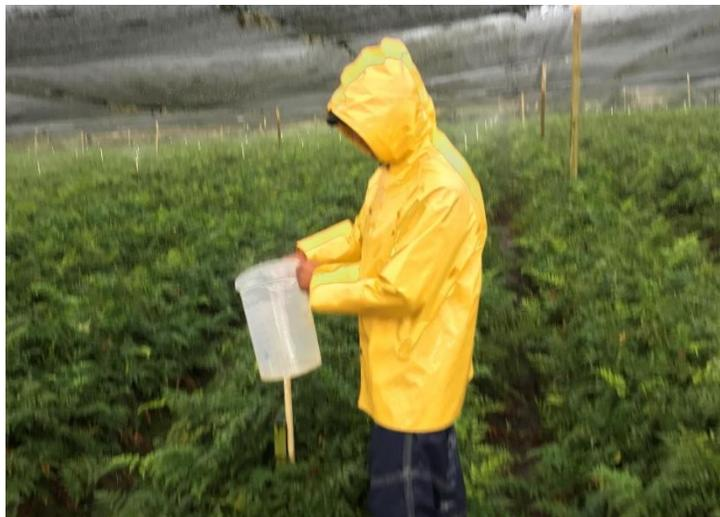
Figura 18. Fotografía de la actividad de aforo del sistema de riego.
