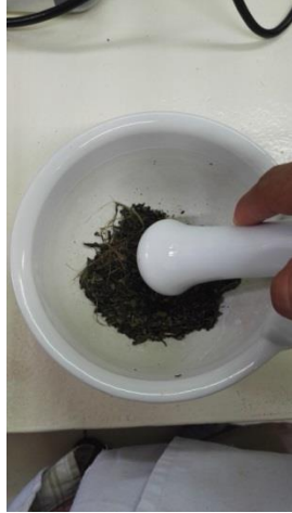
Figura 17A. Maceración de material seco para realizar la extracción de aceites esenciales.
