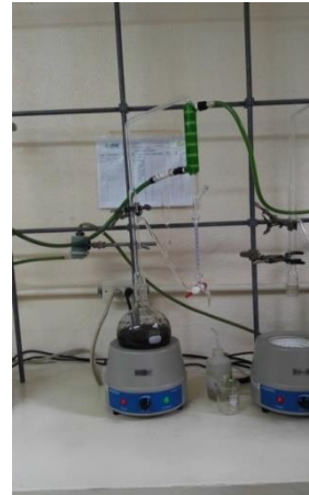
Figura 20A. Equipo Clavenger para realizar la extracción de aceites esenciales.
