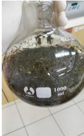
Figura 19A. Matraz de aforo con los 40 g de material seco y 500 ml de agua.
