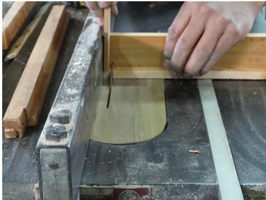
Figura 31. Elaboración de probetas anatómicas con sierra de banco.
