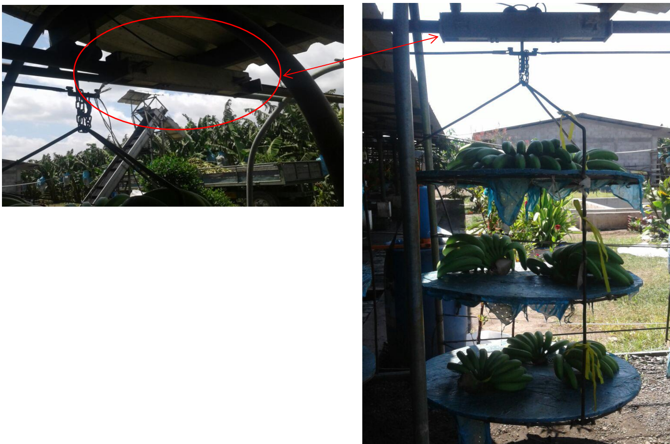
Figura 27. Báscula instalada en la empacadora de la finca, para tomar pesos de racimo.
