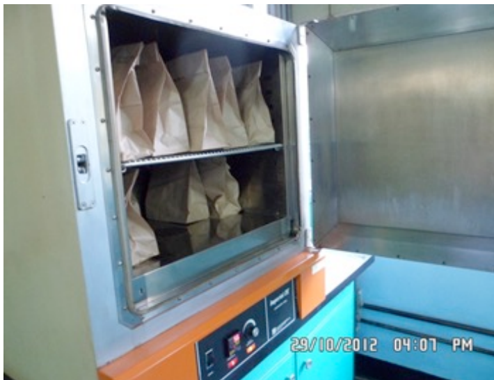
Figura 18. Fotografía de las muestras de biomasa en horno de convección a 60 °C.
