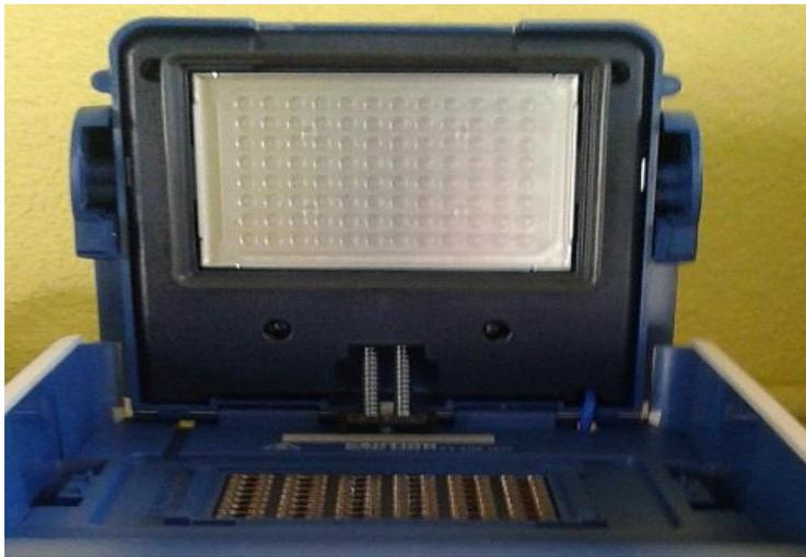
**Figura 23. Termociclador empleado en el proceso de PCR**
