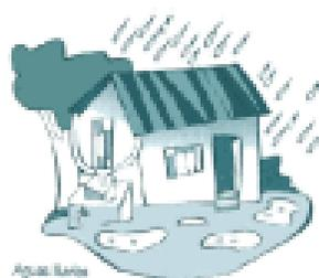
Todo el sistema cuenta con un diseño de autosostenibilidad: si la precipitación llegara a superar la capacidad del sistema, este tiene rebalses para que no colapse; también cuenta con llaves de globo de 2", ya sea para su mantenimiento o si no se requiriera almacenar agua.
