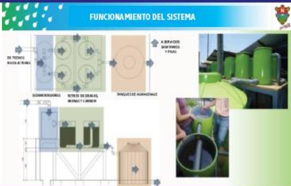
Imagen 5. Sistema de captación de agua de lluvia implementado en la plaza El Amate, zona 1
