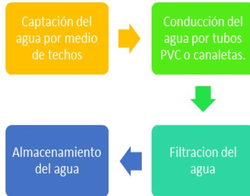
*Figura 30. Funcionamiento general de los sistemas.*
