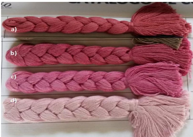
Figura 69. Tonalidades de color rosado usando mordientes y bases: a) base fruto de ilamo, cochinilla y cobre; b) cochinilla, base corteza de aguacate y alumbre; c) cochinilla, hilo blanco y alumbre; d) restos de cochinilla y alumbre.
