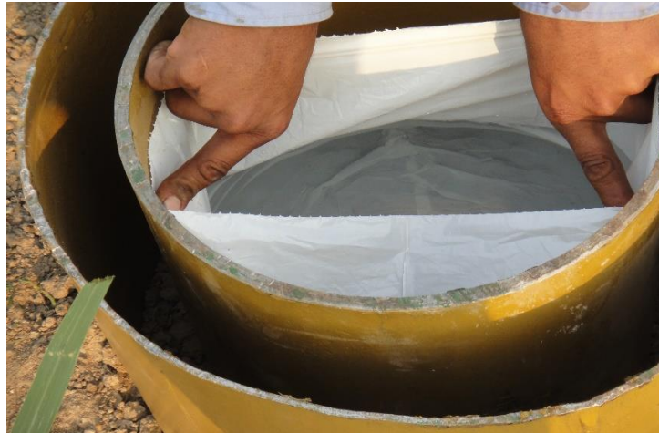
Figura 10. Recubrimiento de cilindro inferior para el inicio de la prueba.
