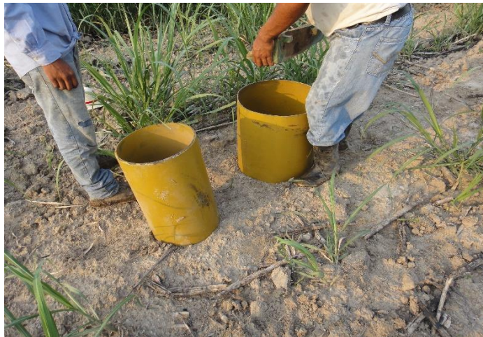
Figura 9. Instalación de infiltrómetro de doble cilindro dentro del surco.
