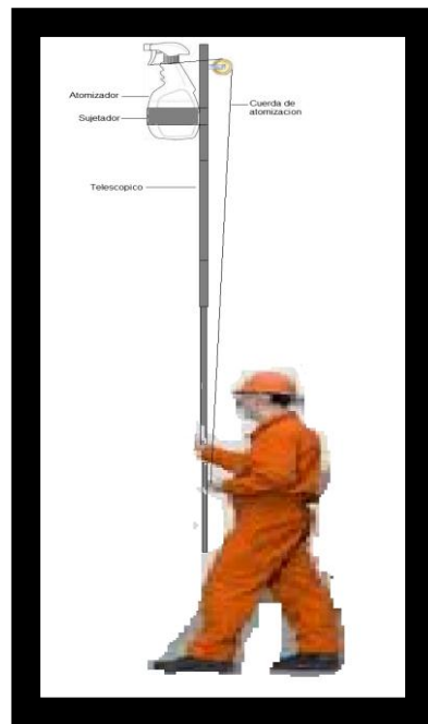
Imagen No. 4. Imagen del diseño del equipo de atomización para Sanitizar las paredes de los silos donde el operario para atomizar únicamente jalara de la cuerda de atomización.
