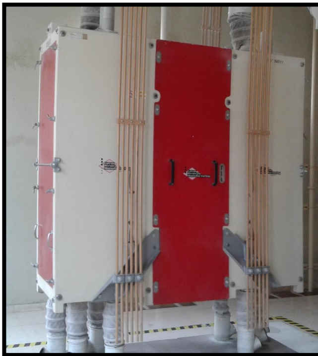
Imagen No. 1. Vista del cernedor de seguridad ubicado en el 2do. nivel del molino de trigo
