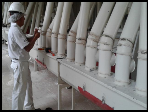
Imagen No. 3. Operario desmontando la tubería
