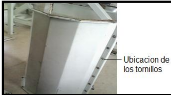
Imagen 3. Ubicación del lugar de los tornillos a quitar para poder retirar la tapadera superior.
