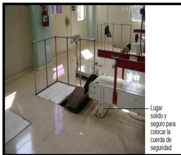
Imagen No. 2. Lugar en donde se enganchara la cuerda de seguridad.
