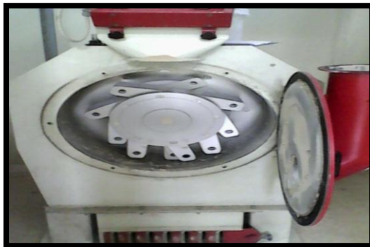
Imagen No. 2. Interior del molino de martillo
