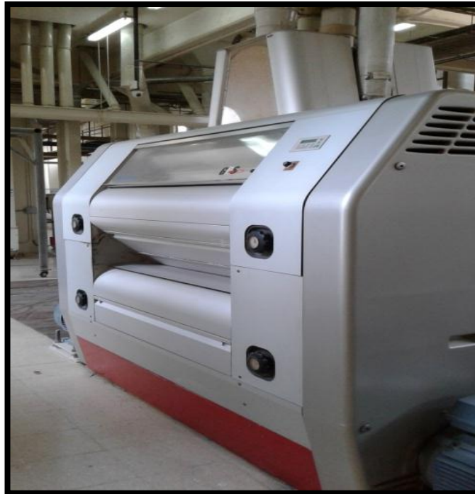
Imagen No. 1. Vista del banco de molienda de 8 cilindros
