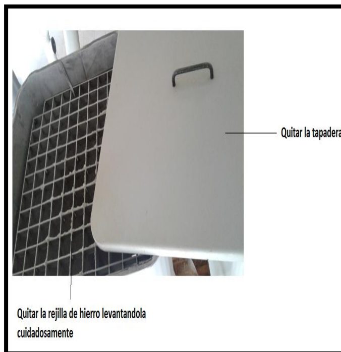
Imagen No. 2. Tapadera y rejilla de hierro ubicada en el interior de la tolva
