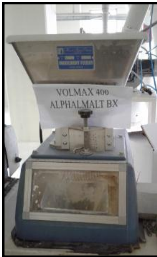
Imagen No. 1. Vista de una de las tolvas de mejorantes reológicos instaladas en el tornillo transportador de harina de los silos 8, 9, 10, 11, 12, y 13 ubicados en el 1er. nivel, área de empaque.
