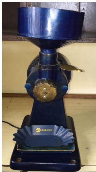
Figura 41. Molino para muestras.
