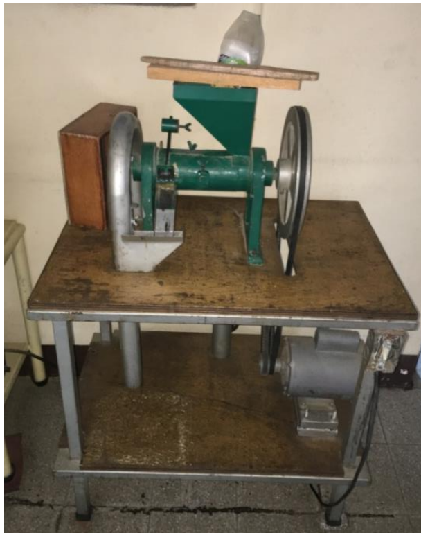
Figura 39. Trilladora para muestras
