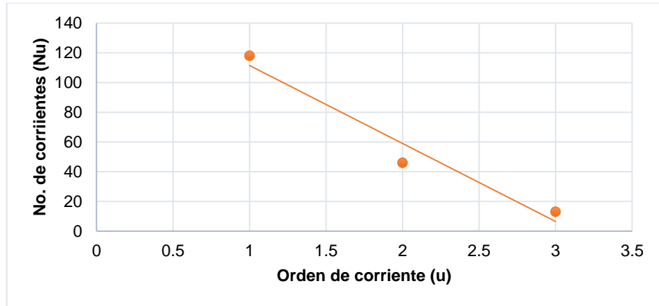
Figura 11. Gráfica de orden de corrientes y número de corrientes de la sub cuenca del río La Plata
