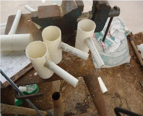
Figura 12A. Preparación de drenaje para el sistema -NFT-.
