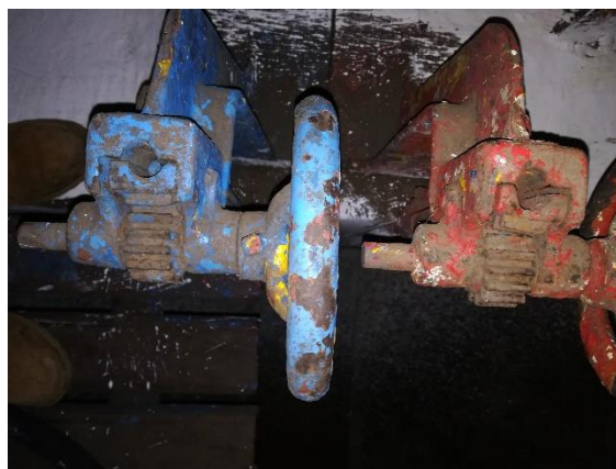
Figura 94. Falta de lubricación en engranajes
