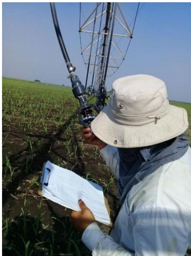
**FIGURA 47. INSPECCIÓN DE CALIDAD EN AVANCE FRONTAL, INSPECCIÓN DE BOQUILLAS.**
