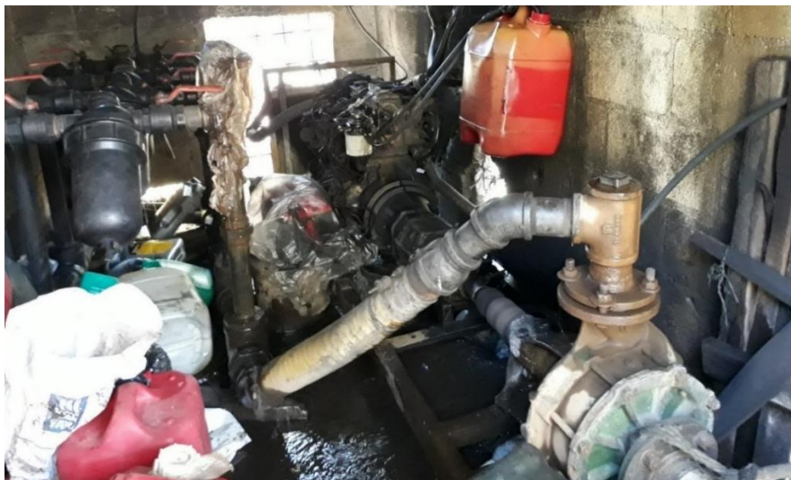
Figura 8. Bodega del motor de camión de la bomba de riego en la finca Las Gemelas.
