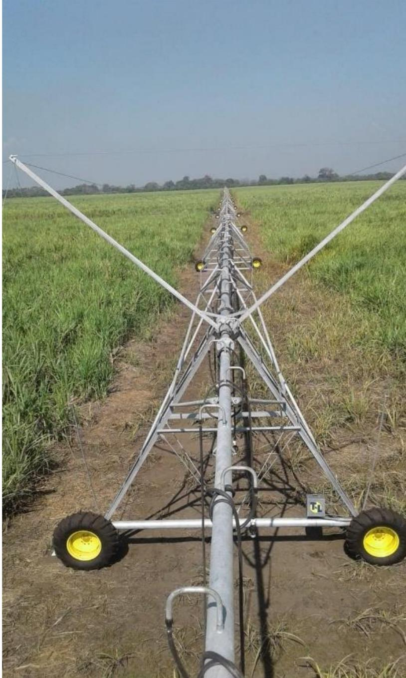
**FIGURA 47A. SISTEMA DE RIEGO POR AVANCE FRONTAL APLICADO EN LOS LOTES EVALUADOS**
