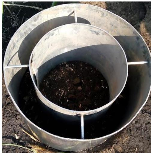
**FIGURA 61. FORMA CORRECTA DE COLOCAR LOS CILINDROS INFILTROMETROS**
