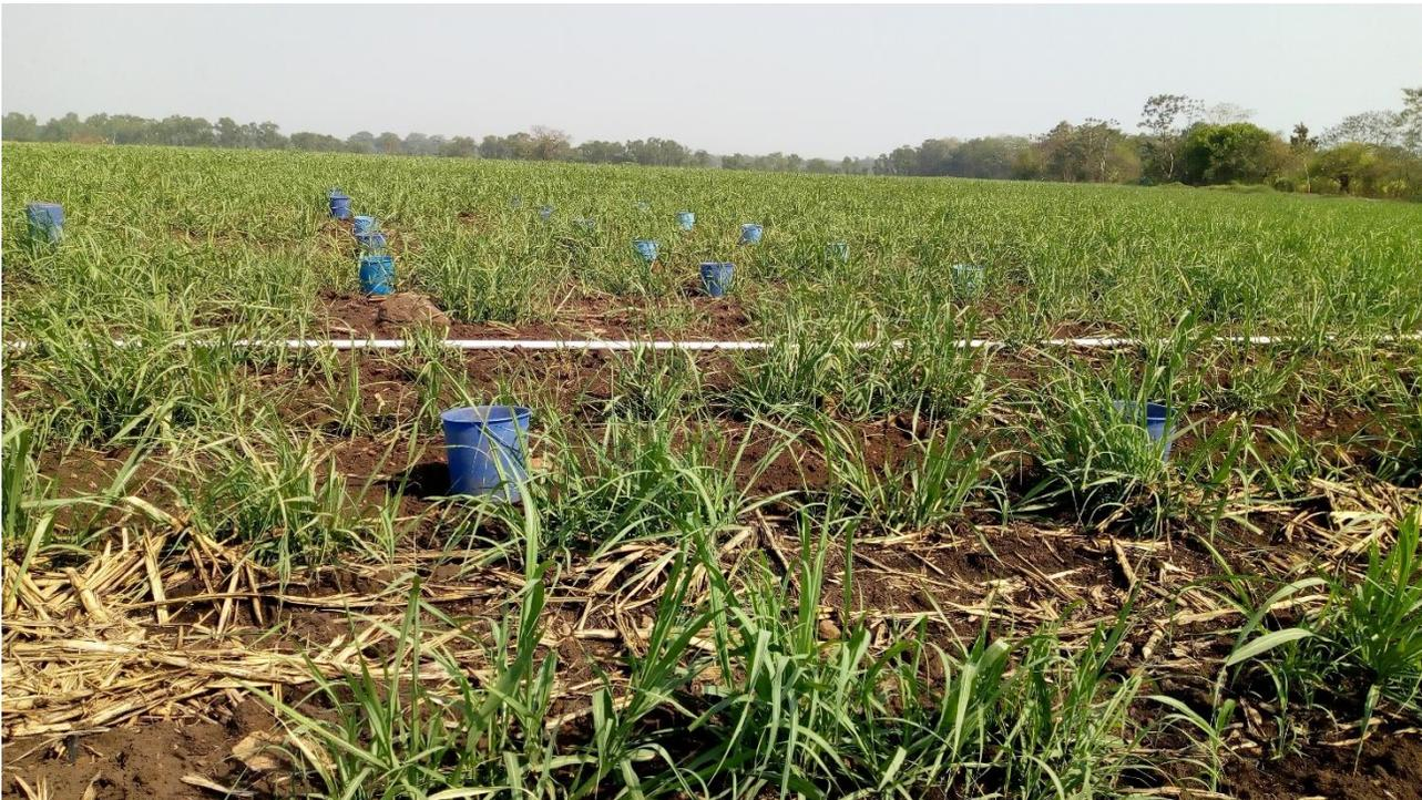
**FIGURA 3. INSTALACIÓN DE RECIPIENTES DURANTE PRUEBA DE UNIFORMIDAD**
