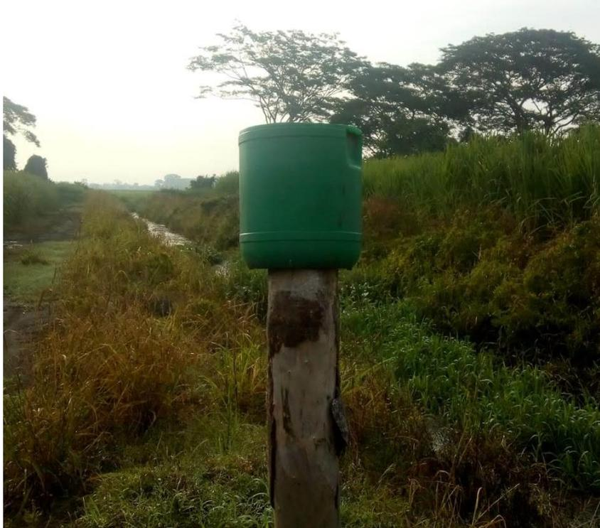
**FIGURA 28. PLUVIÓMETRO INSTALADO EN LA FINCA AGROPECUARIA CENTROAMERICANA**
