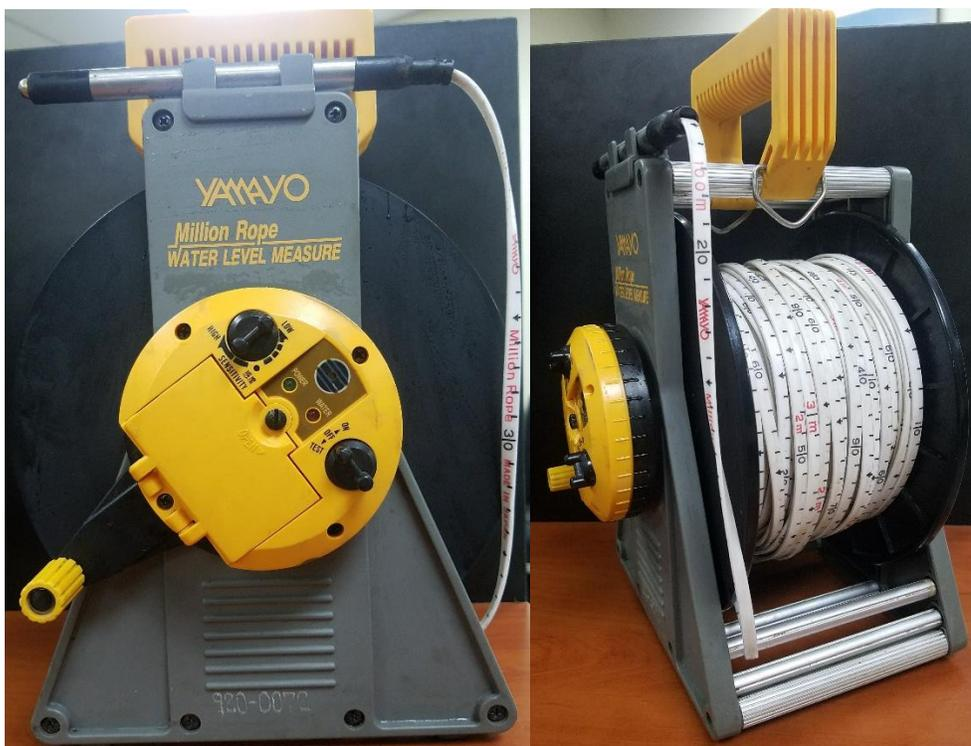
**FIGURA 51. SONDA HIDROSENSIBLE PARA EL MONITOREO DEL NIVEL FREÁTICO DEL AGUA**
