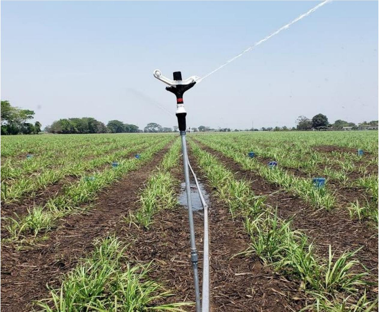
**FIGURA 4. PRUEBA DE UNIFORMIDAD REALIZADA EN SISTEMA DE RIEGO POR
