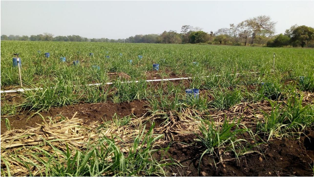
**FIGURA 21A. PRUEBA DE UNIFORMIDAD REALIZADA EN SISTEMA DE RIEGO POR MINI ASPERSIÓN**
