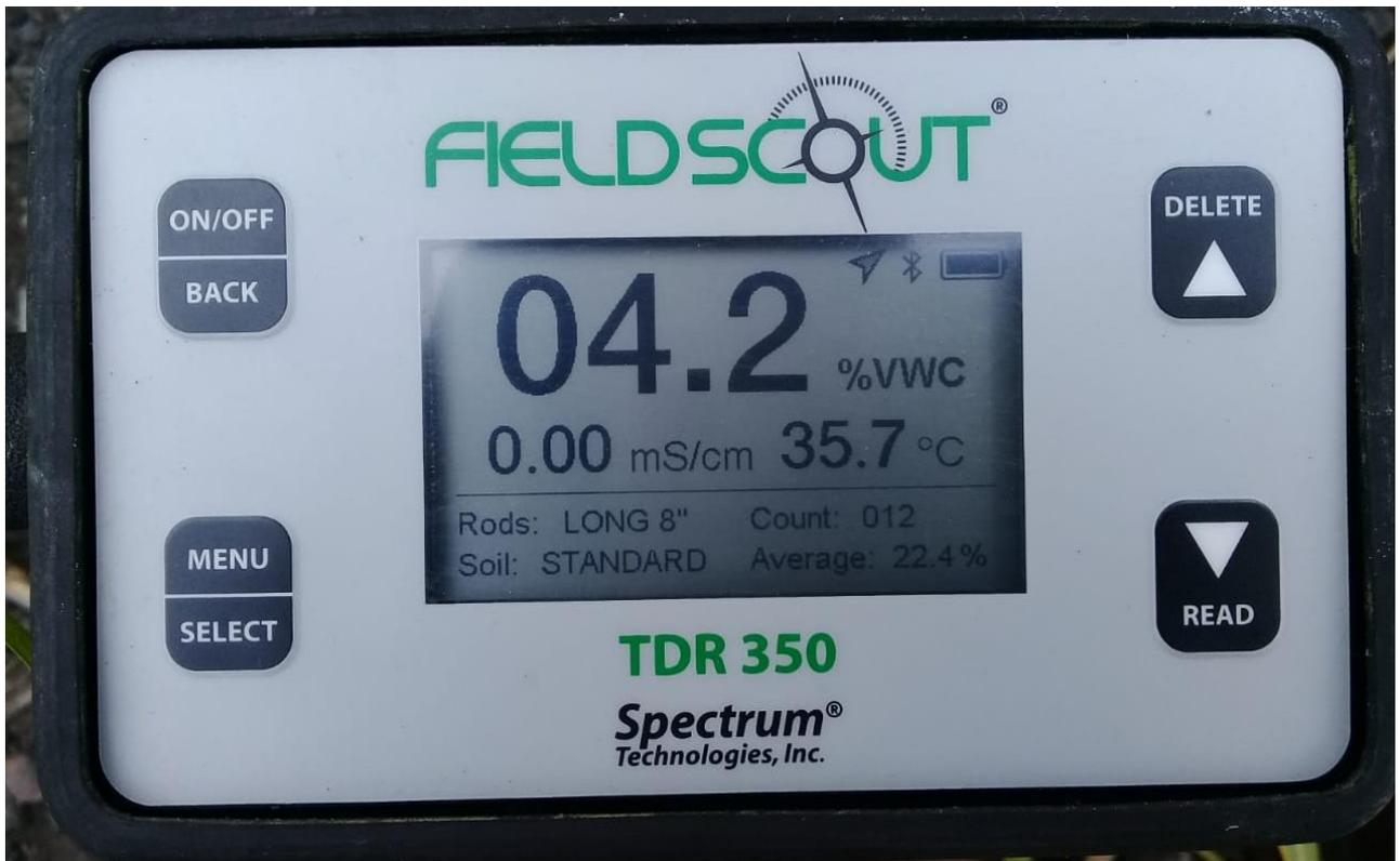
**FIGURA 32. SONDA DE HUMEDAD TDR-350**
