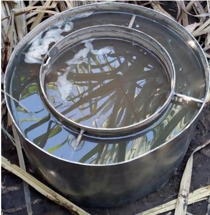
**FIGURA 62. NIVEL DE AGUA EN LOS CILINDROS DE INFILTRACIÓN**
