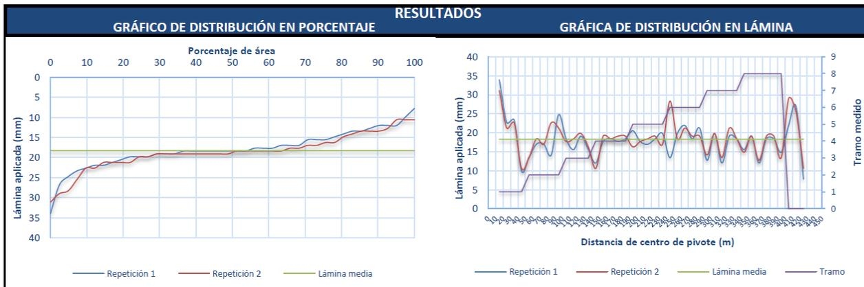
**FIGURA 22A. RESULTADOS OBTENIDOS EN PRUEBA DE UNIFORMIDAD REALIZADA EN PIVOTE CENTRAL**
