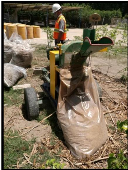
Figura 21. Picadora de zacate utilizada para el tule.
