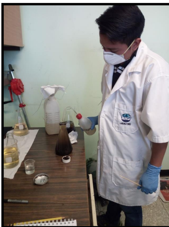
Figura 85. Proceso de flotación de nemátodos de quites con la ayuda de un erlenmeyer.
