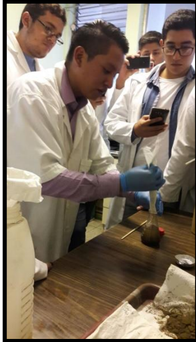
Figura 49. Suelo extraído por el aparato de Fenwick, realización de flotación de nemátodos de quiste con la ayuda de acetona en un Erlenmeyer.
