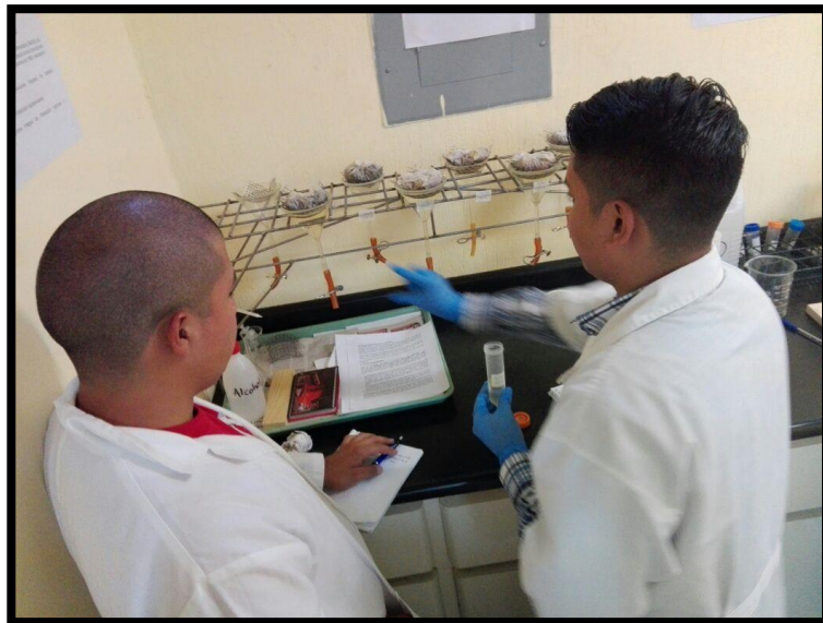
Figura 42. Explicación a un estudiantes del primer semestre 2017 del Lab. Introducción a la fitopatología de como se debe de extraer una muestra por el método embudo de Baermann.
