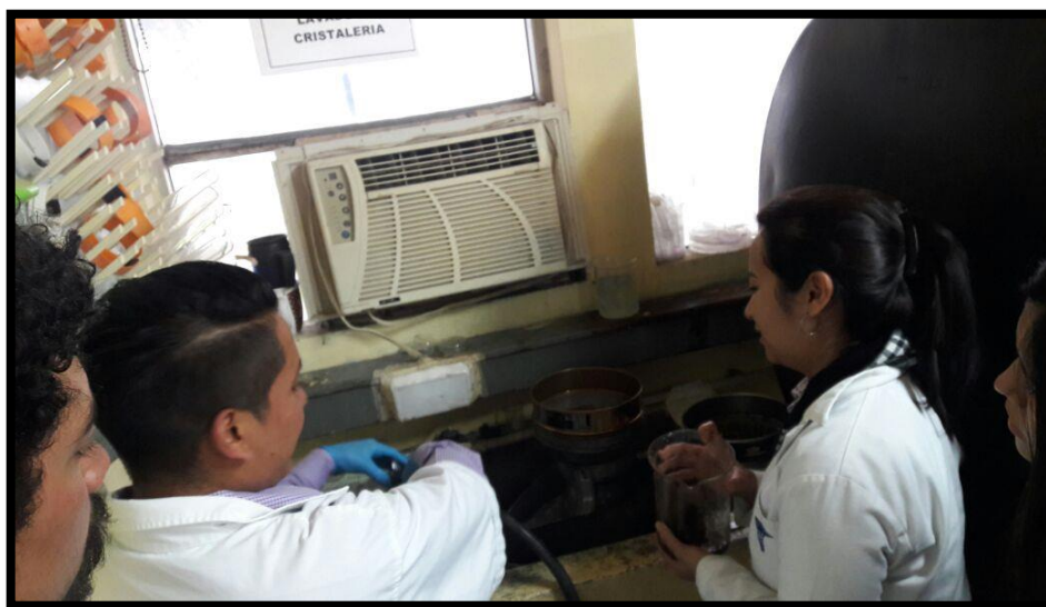
Figura 47. Explicación a estudiante (curso patología forestal) de cómo se utiliza el aparato de fenwick para la extracción de nemátodos formadores de quiste.
