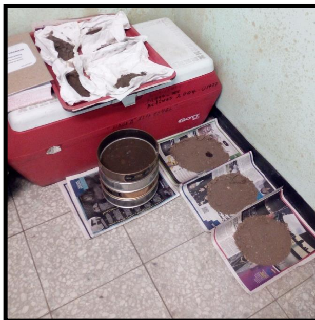
Figura 81. Proceso de secado de muestras de suelo con requerimiento nematológico para análisis de nemátodos formadores de quiste.
