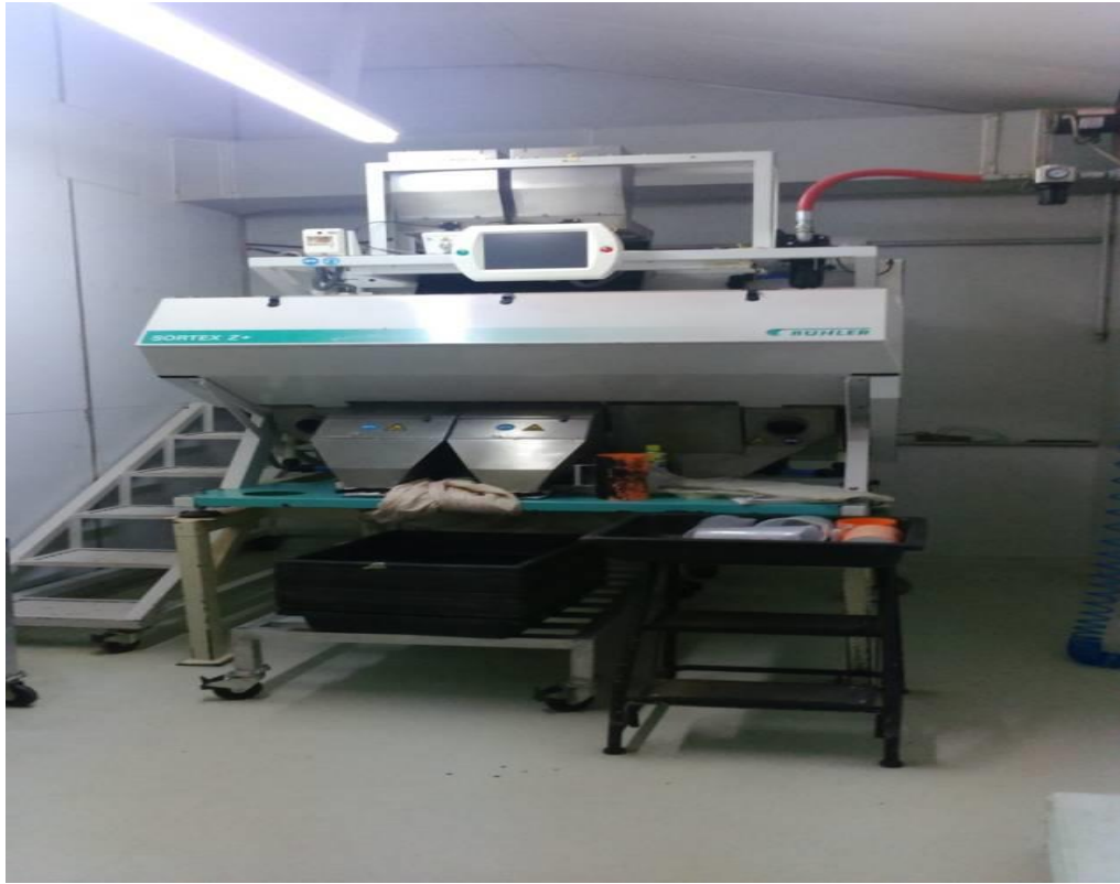
Figura 22A. Separación por máquina Sortex®, máquina que separa las pupas por color a base de aire.
