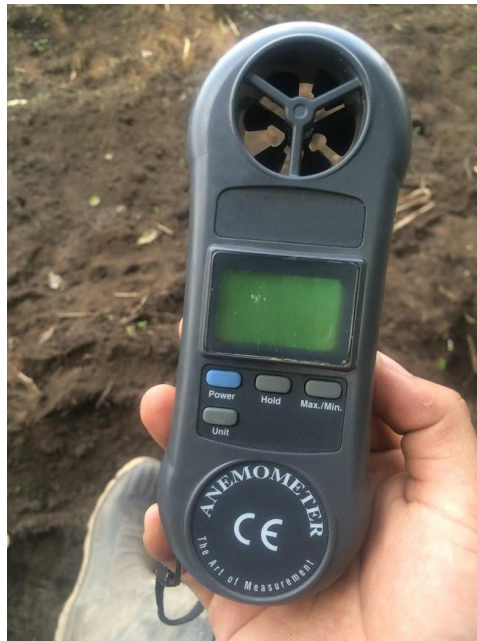
Figura 128. Anemómetro portátil para medición de velocidad de viento durante prueba
