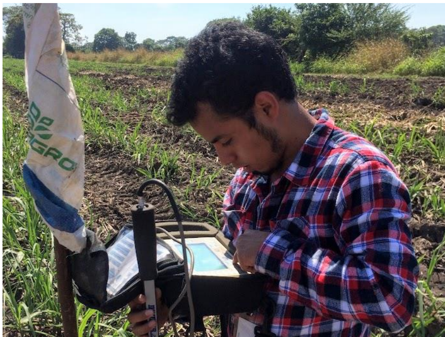
Figura 120. Monitoreo de humedad usando la sonda FDR DIVINER 2000®
