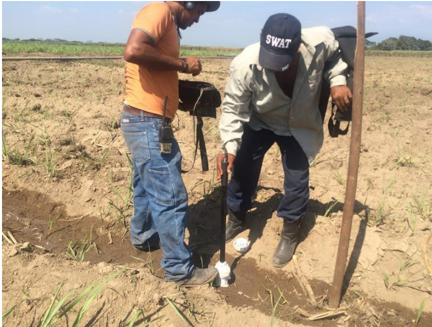
Figura 51. Medición de puntos de muestreo con sondas FDR en campo
