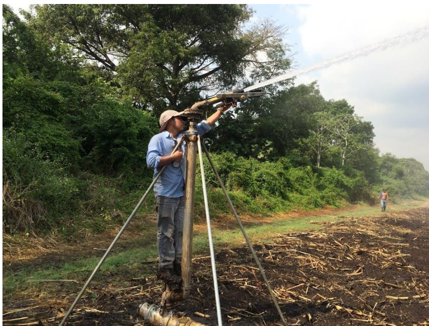
Figura 127. Medición de presión de salida de agua de aspersor Komet Twin 101 Plus
