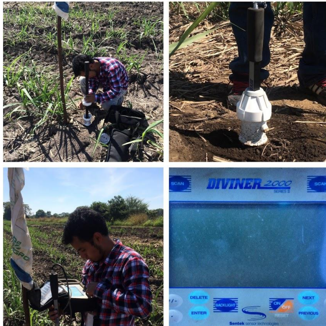
Figura 105A. Instalación de puntos de monitoreo con sonda FDR en área de investigación
