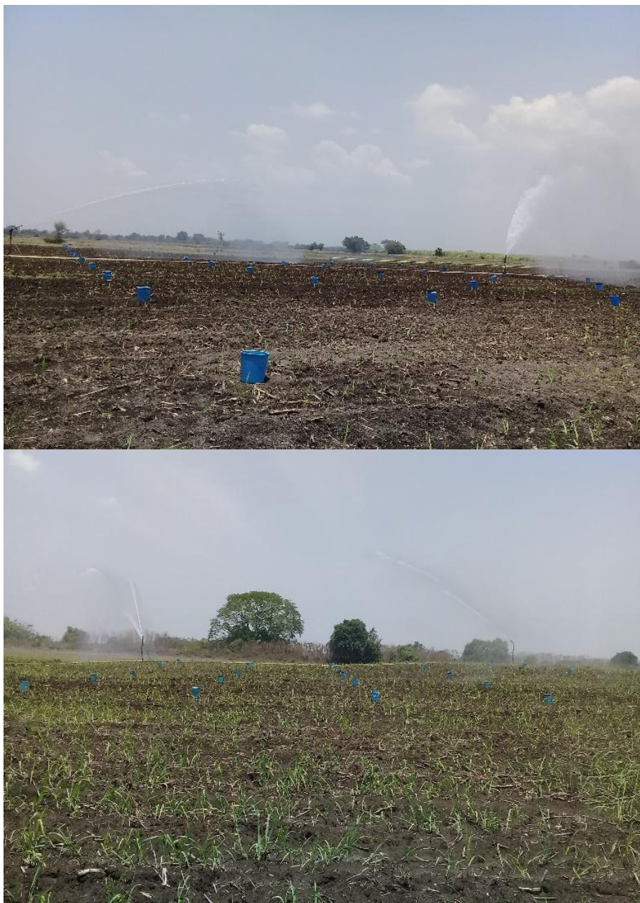
Figura 50. Fotografías de pruebas de uniformidad realizadas en equipos de riego por aspersión tipo cañón.
