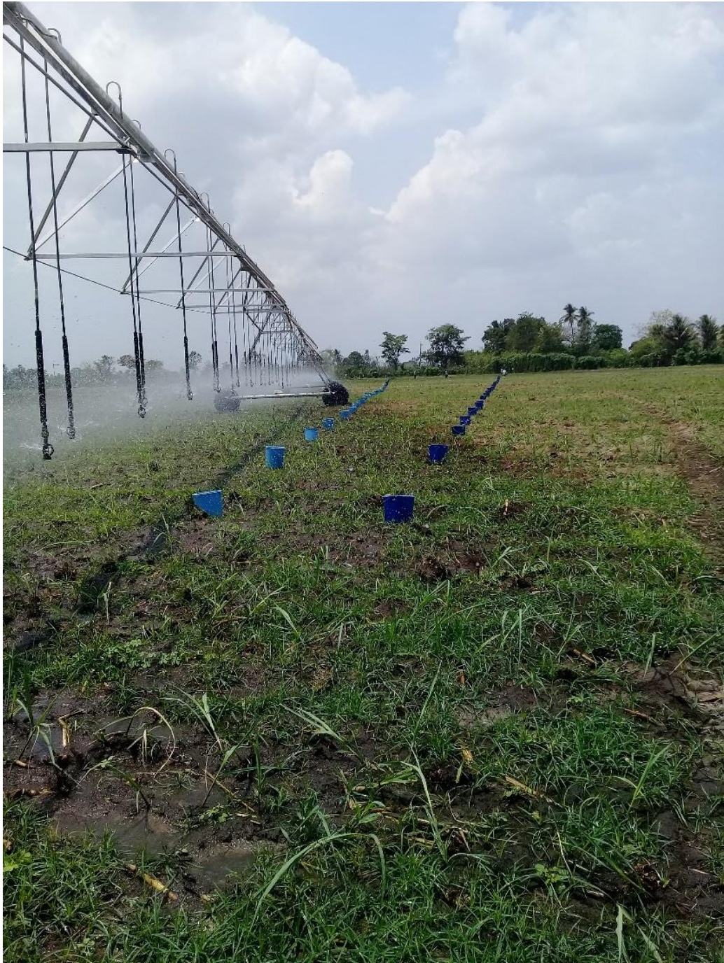
Figura 51. Prueba de uniformidad realizada en pivote central.
