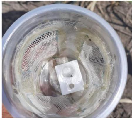
Figura 69A. Tipo de difusor blíster "A".    Figura 70A. Difusor colocado en vaso tipo jaula.
