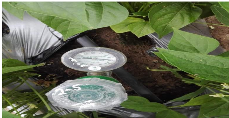
Figura 4. Tensiómetros colocados en parcelas.
