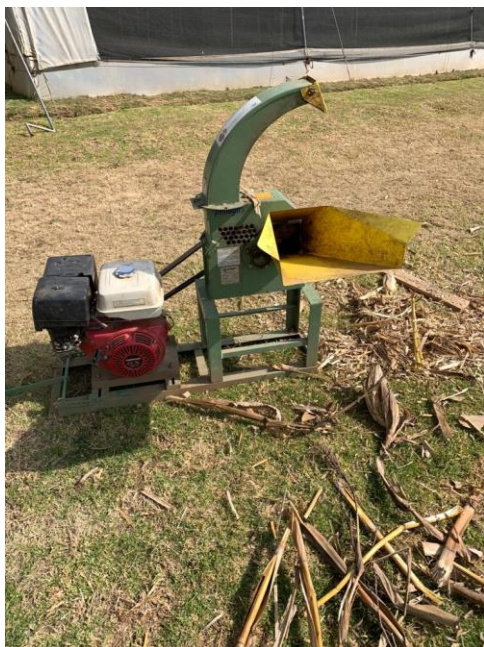
Fuente: elaboración propia, 2019. Figura 72A. Picadora utilizada para cortar la caña de maíz.
