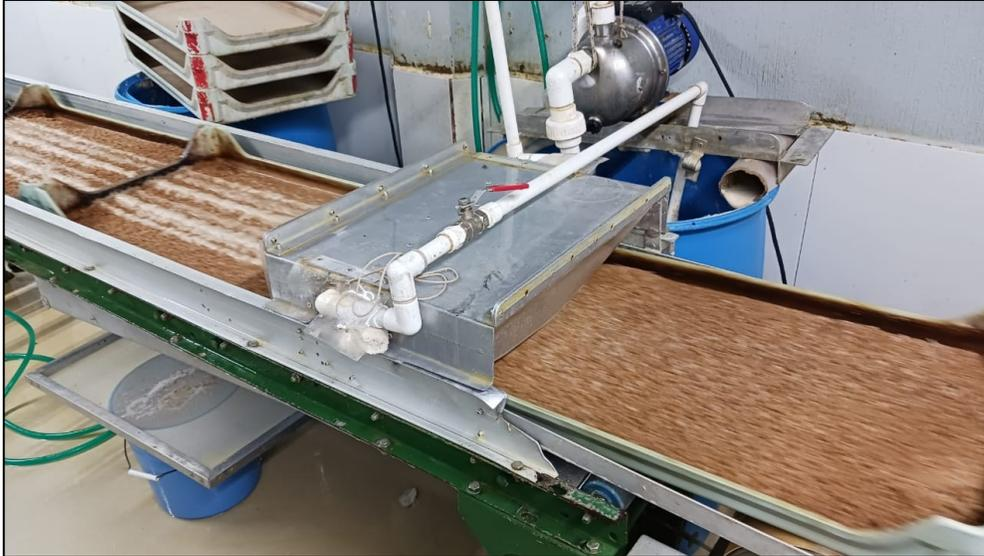
**Figura 15** Aplicación de solución nutritiva en el manejo hidropónico durante la maduración larval.
