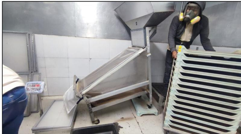
**Figura 21** Volteo de bandejas para la separación de dieta y pupa.
