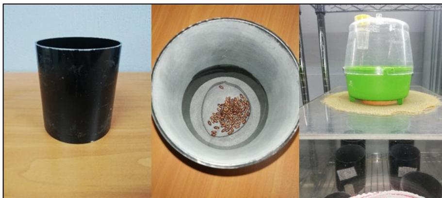
**Figura 25** Cilindros para la prueba de porcentaje de voladoras.
