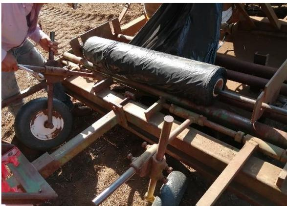
Figura 143. Encamadora.
