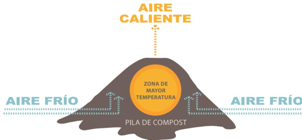
Figura 7. Movimiento de aire en la pila.
