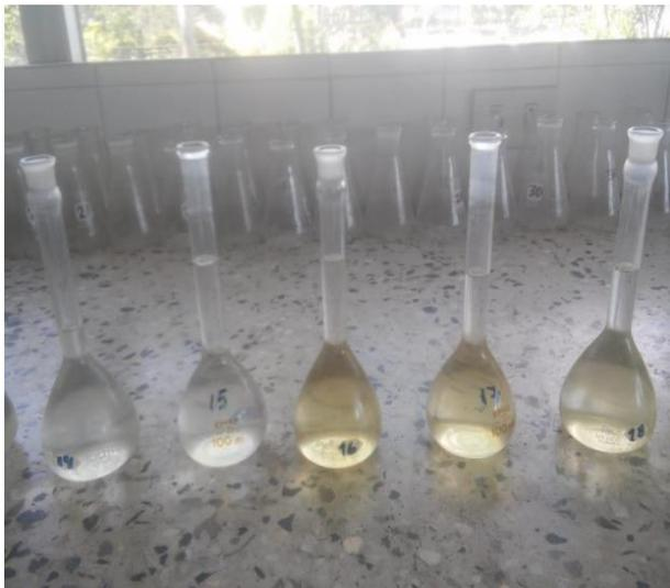
Figura 10. Extractos de bases intercambiables.
