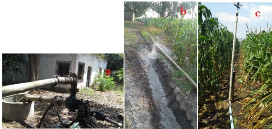
Figura 6. Sistema de riego por aspersión utilizado para el riego del cultivo de maíz. Sistema de bombeo (a), fugas en tuberías secundarias (b) y aspersores de 3 metros de altura (c).
