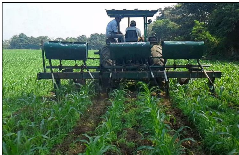
Figura 9. Aplicación de fertilizante al cultivo de maíz de 30 días, utilizando una abonadora de tres tolvas accionada por un tractor.
