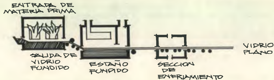
FIG. 36-FABRICACION DE VIDRIO LAMINADO
