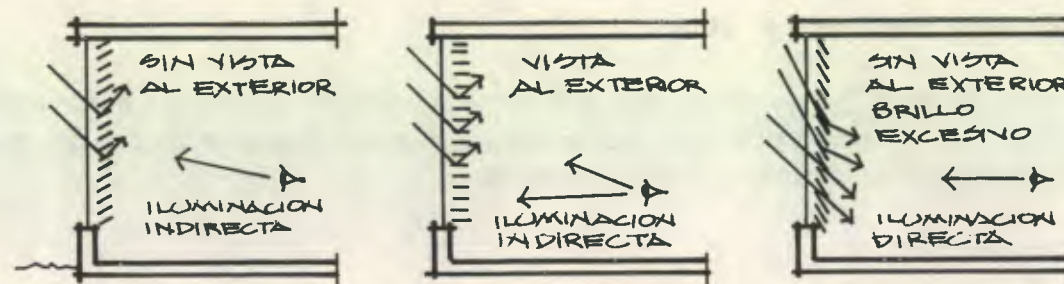
FIG. 31- USO DE PERSIANAS VENEZIANAS, INCIDENCIA DE LUZ SOLAR Y SUS EFECTOS SEGUN EL ANGULO DE INCLINACION
