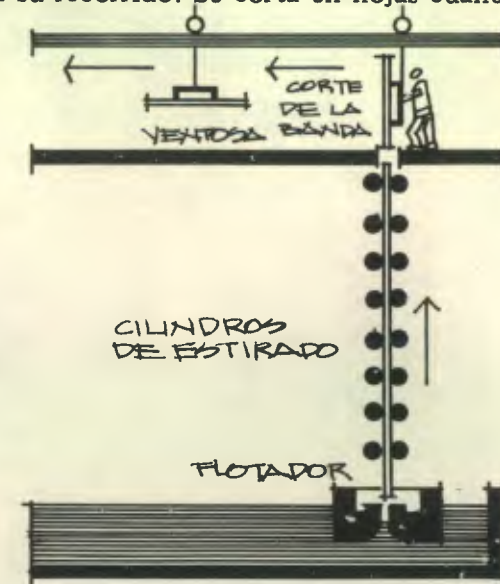
FIG. 34 - FABRICACION DE VIDRIO ESTIRADO
