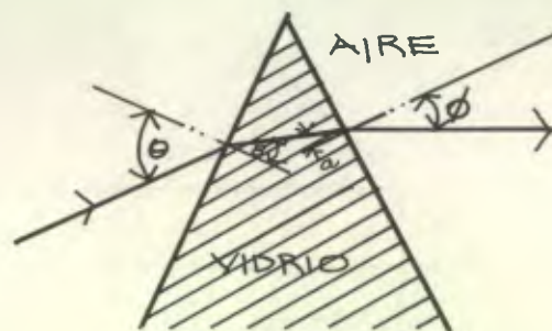
FIG. 10- PRINCIPIO DEL PRISMA REFRACTARIO
