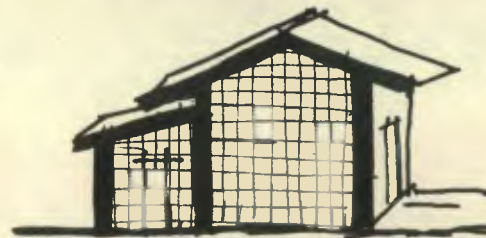
TECHO DE UNA Y DOS AGUAS
